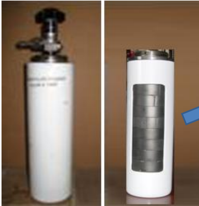
Cilindros de adsorción con monolitos comerciales
