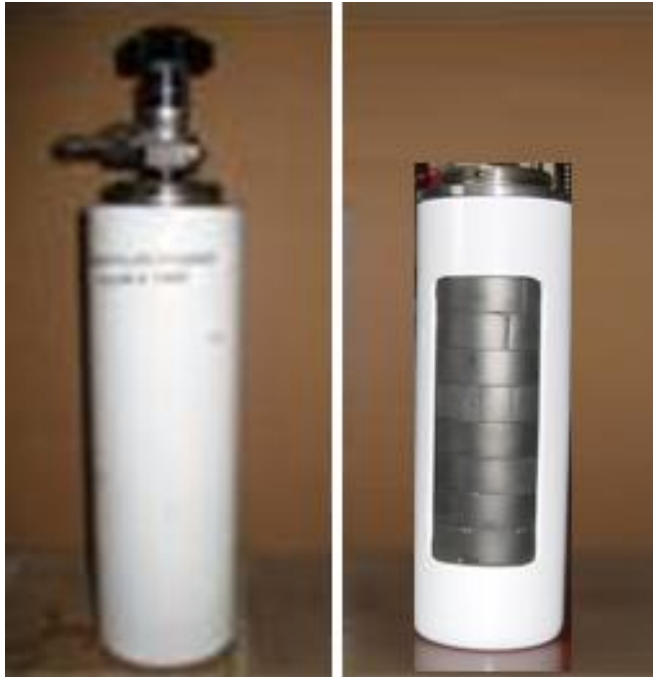
Cilindros de adsorción con monolitos comerciales
